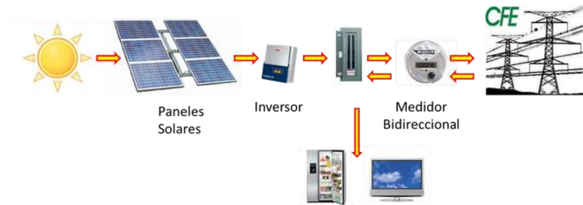
Imagen 68. Diagrama de un Sistema Interconectado. ( https://www.energyclean.com.mx/kits-aislados/ ).
