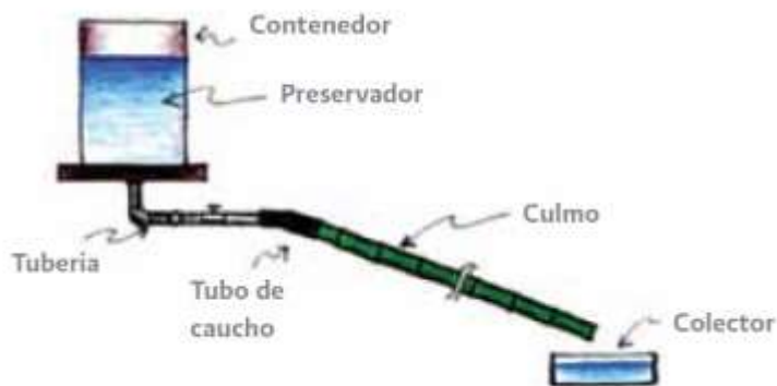
Figura2. Tratamiento preservador del bambú por el método de Boucherie/ (SEMARNAT, 2014).
