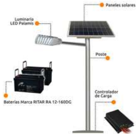
Imagen 70. Poste solar/ Diagrama de Funcionamiento. ( https://www.energyclean.com.mx/kits-aislados/ ).
