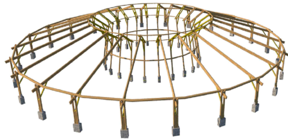
Estructura tipo del conjunto
