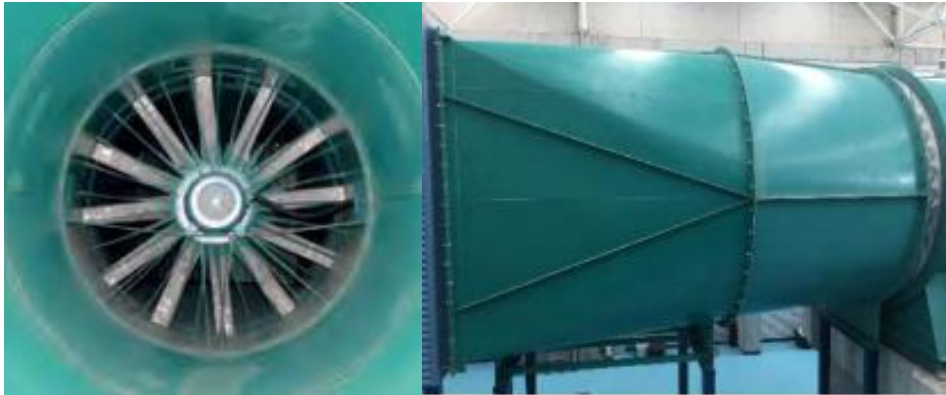
Figura 4.8 Ventilador y difusor del túnel de viento de la UNAM. Recuperado de: https://bit.ly/2PVA9YZ el 23 de mayo, 2019.
