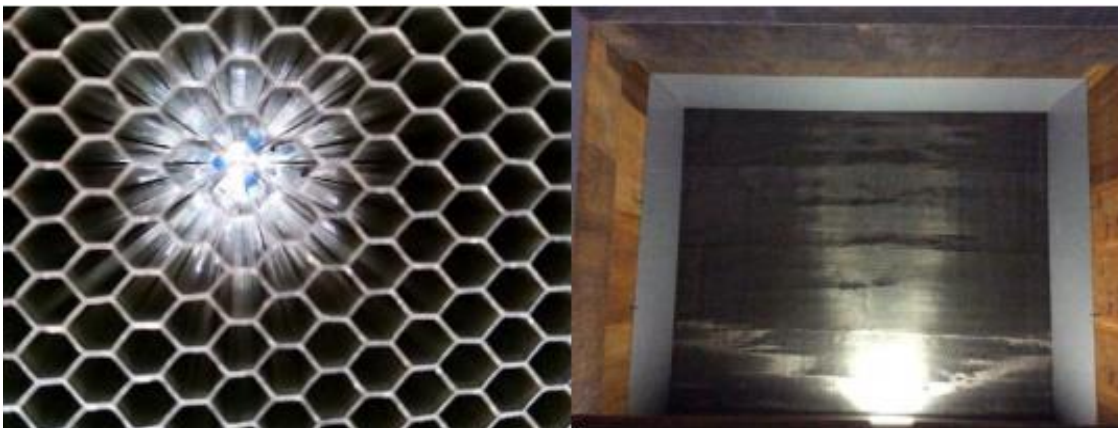
Figura 4.9. Estabilizador de flujo y pantalla de turbulencia. Recuperado de: https://bit.ly/2PVA9YZ el 23 de mayo, 2019.
