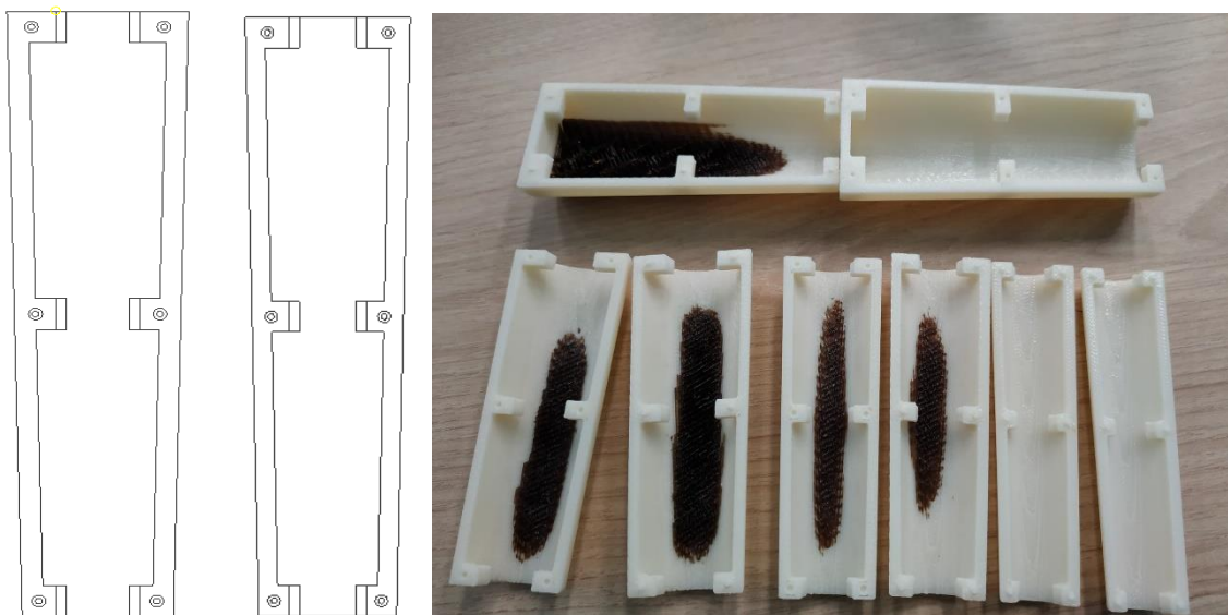
Figura 4.4 a) Croquis de una sección del modelo, b) Piezas impresas en 3D.
