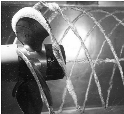
Figura 1.1: Fotos en las que se muestra a) la generación de burbujas de cavitación en una hélice y b) el daño provocado por las burbujas sobre la hélice [2]
