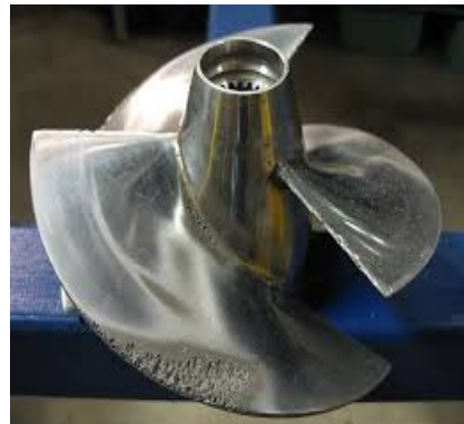
Figura 1.1: Fotos en las que se muestra a) la generación de burbujas de cavitación en una hélice y b) el daño provocado por las burbujas sobre la hélice [2]
