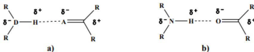
Figura 1. a) Representación clásica del puente de hidrógeno, b) puente de hidrógeno establecido entre un grupo carbonilo (aceptor) y un grupo amino (donador).<sup>11</sup>
