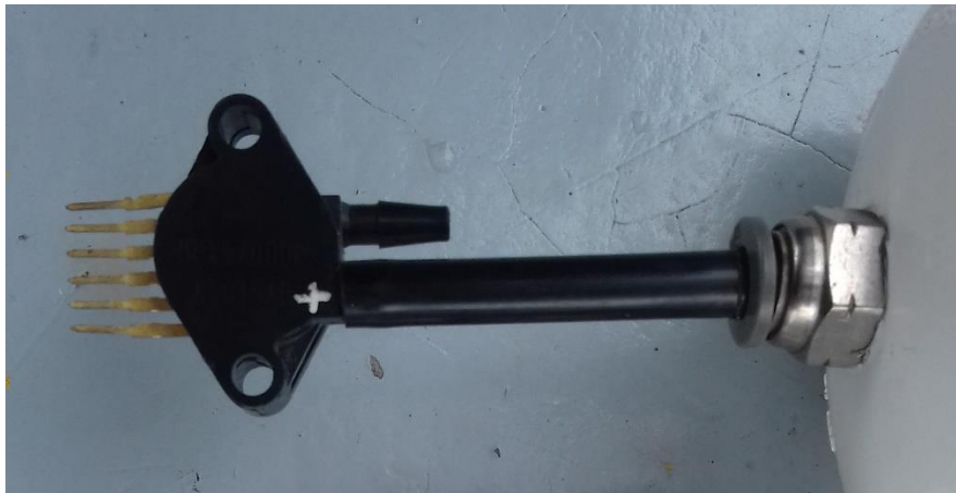
Imagen 4.44 acoplamiento del sensor MPX5700
