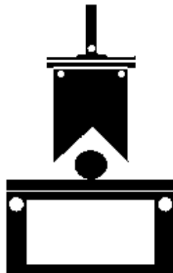
Figura 4. Diagrama representativo de la prueba de fuerza de corte (Food Technology Corporation, s.f.). Vista frontal.
