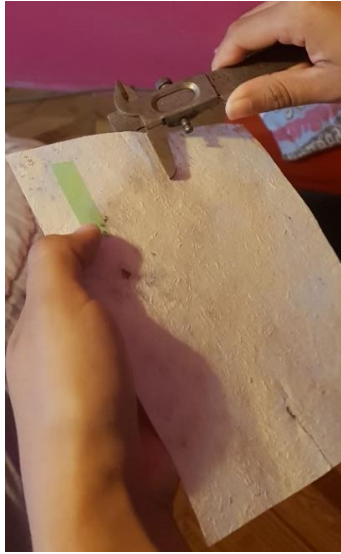
Figura 26. Medición del espesor de las hojas de papel.
