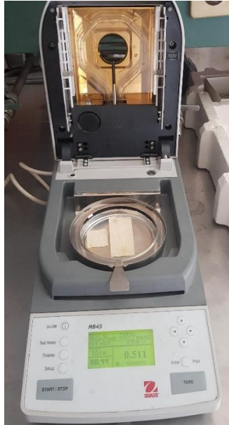
Figura 29. Obtención del contenido de humedad en las hojas de papel.
