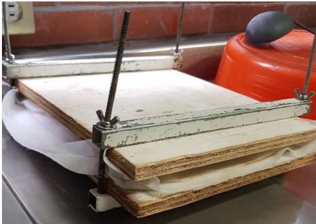
Figura 14. Prensado de las hojas húmedas.
