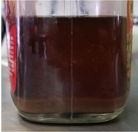
Figura 18. Precipitado de la lignina.
