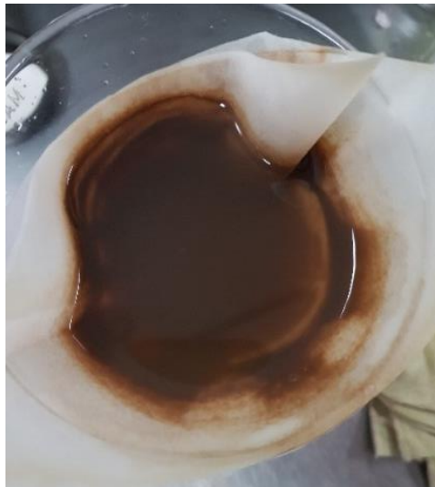
Figura 19. Filtrado y lavado de la lignina.
