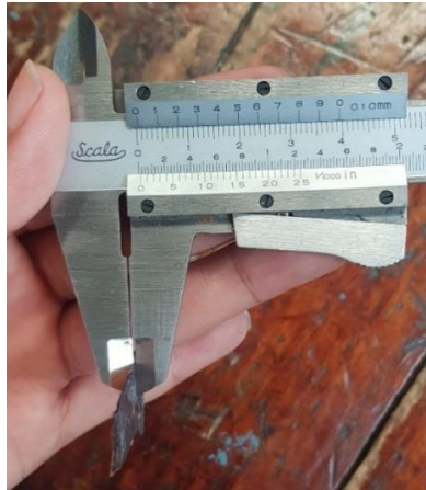
Figura 38. Determinación del espesor del bio-plástico.
