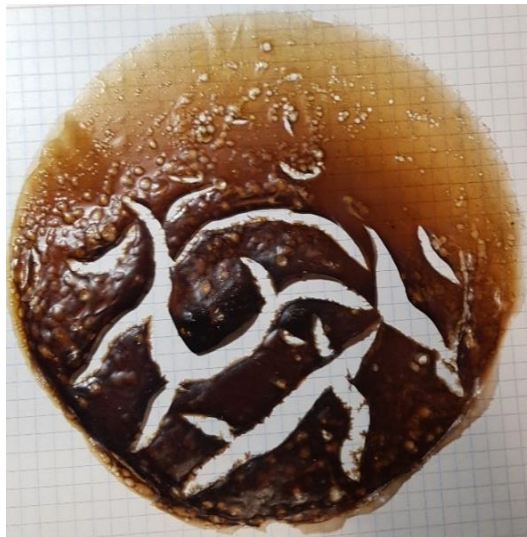
Figura 24. Obtención de la película de bio-plástico.
