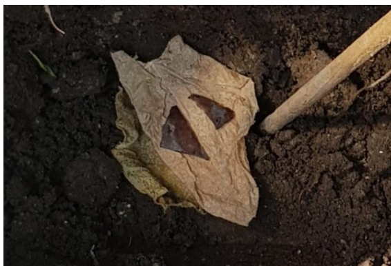
Figura 42. Muestras de bio-plástico antes de ser enterradas.
