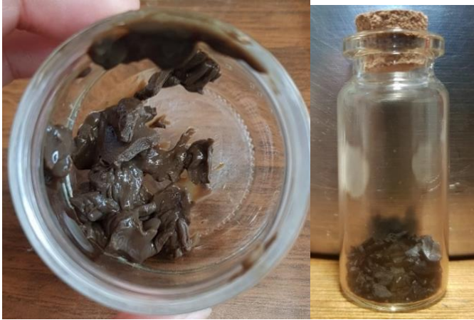
Figura 20. Lignina antes y después del secado (izquierda y derecha respectivamente).
