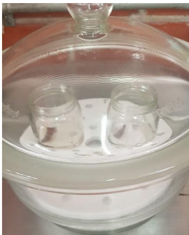
Figura 39. Muestras del bio-plástico en el desecador para la determinación de la permeabilidad en agua.
