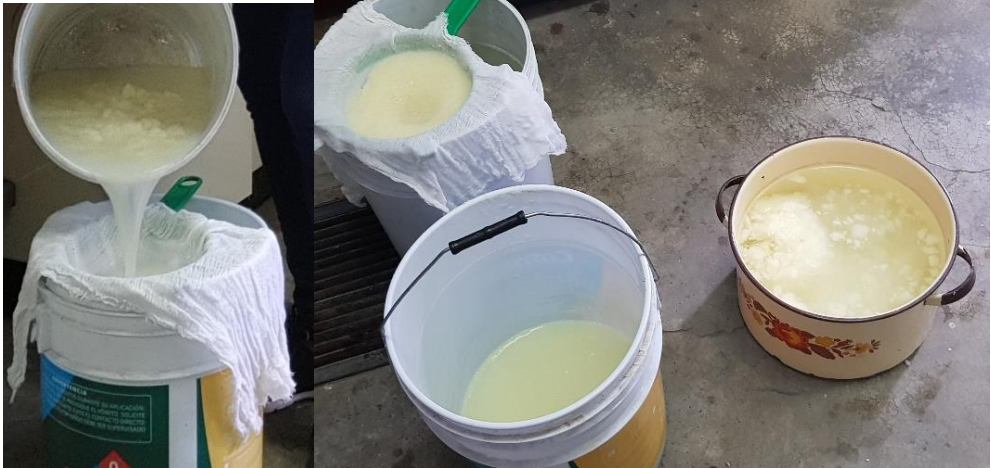
Figura 12. Segundo lavado de la fibra celulósica.
