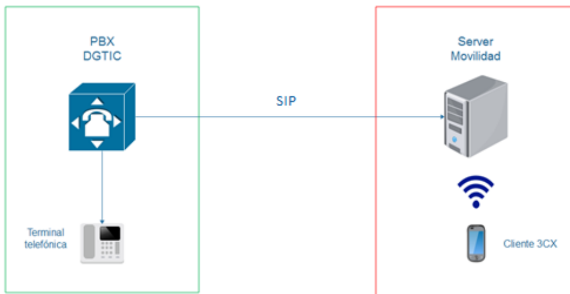
Figura 50 Enlace IP entre PBX y Servidor
