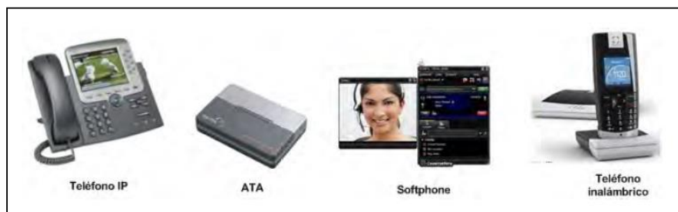
Figura 44 Terminales de telefonía IP.
