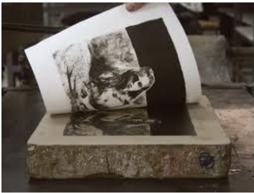
Figura 59. Litografía en piedra. Fuente: Definición de litografía. https://www.definicionabc.com
