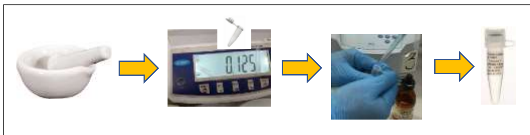
Figura 22. Esquema que muestra la metodología de la disgregación del tejido de la muestra.
