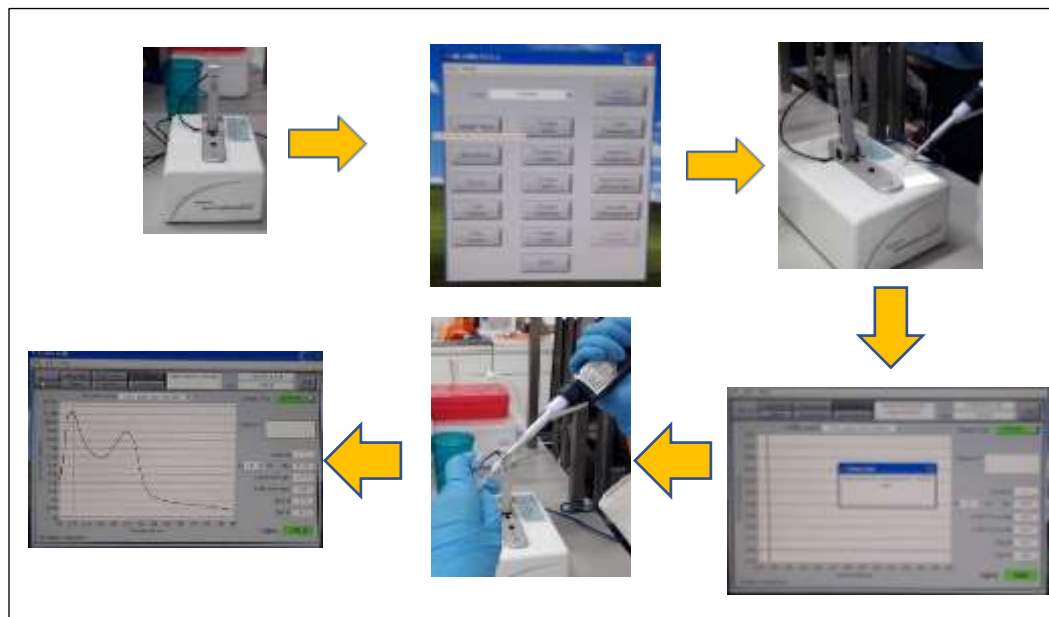
Figura 25. Esquema que muestra los pasos para la cuantificación del DNA.
