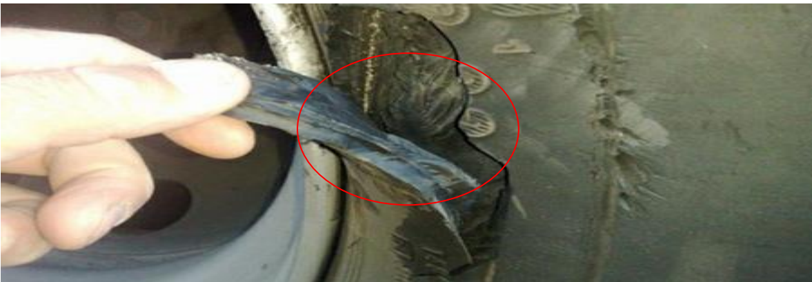
Figura 3.1. Ceja dañada por tecnica inapropiada de montaje o desmontaje
