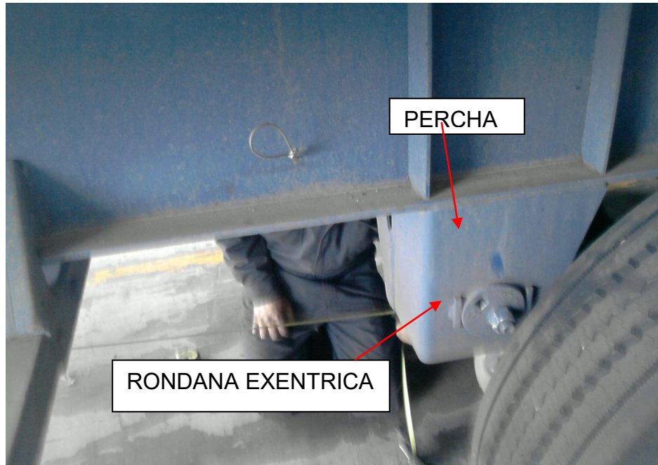
Figura 2.8 Percha y rondana de ajuste
