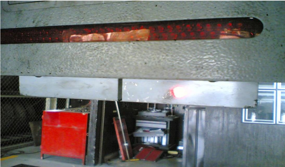
Figura 2.7 Pantalla receptora del láser, nos indica la desviación del eje lo que requiere de alineación.
