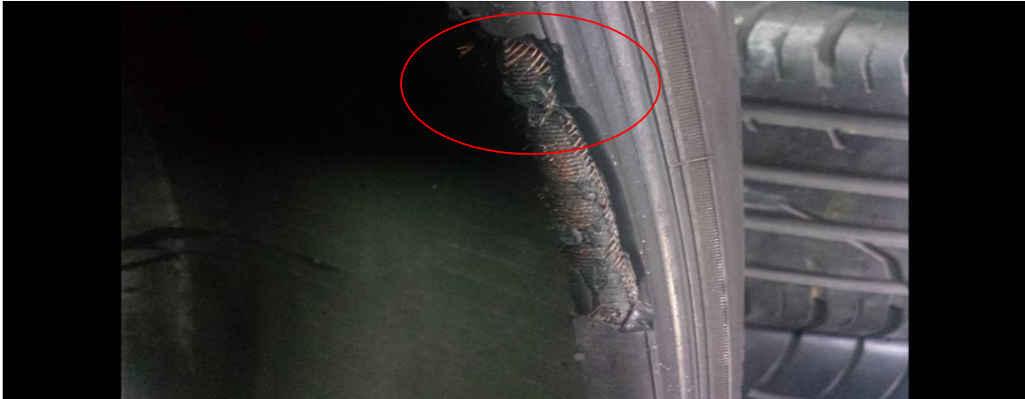
Figura 3.2 Daño en ceja
