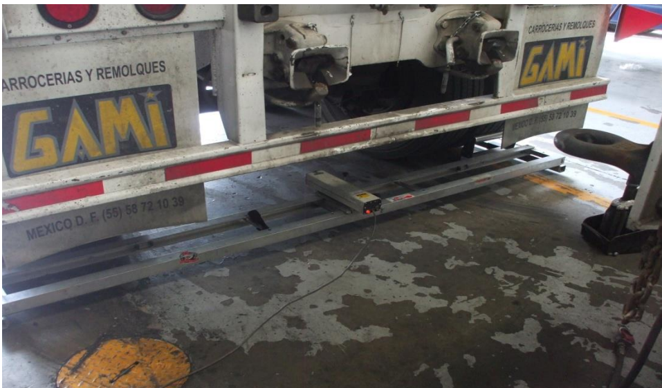
Figura 2.6 Colocación del laser en los ejes del remolque
