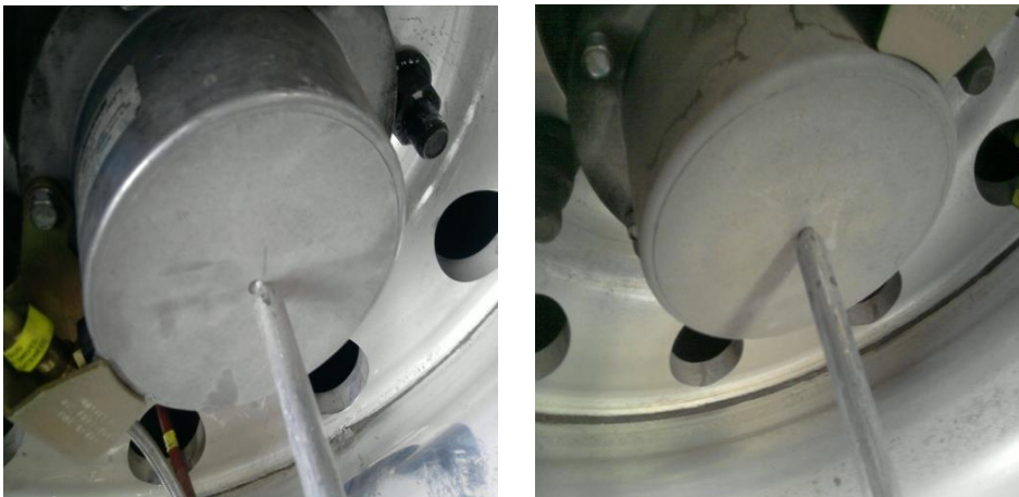
Figura 2.10 de la lectura obtenida del lado opuesto con el escantillón
