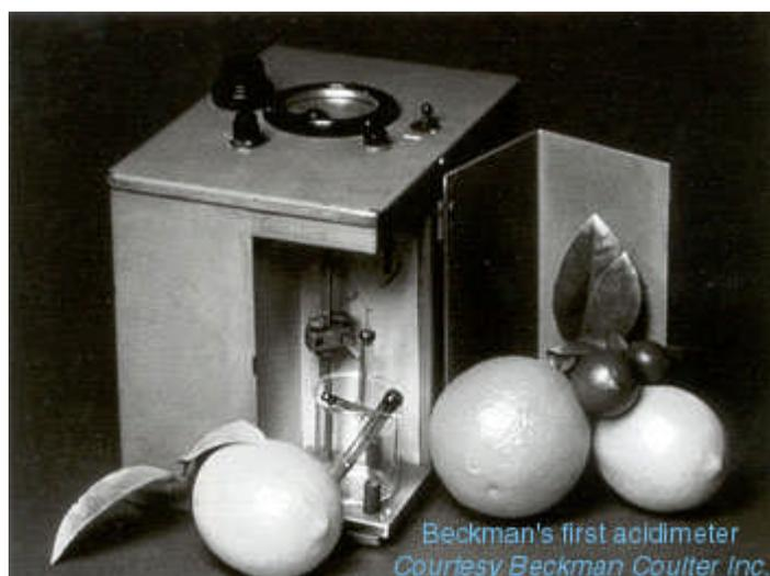
Fig. 2. Primer potenciómetro, llamado inicialmente acidímetro.<sup>6</sup>
