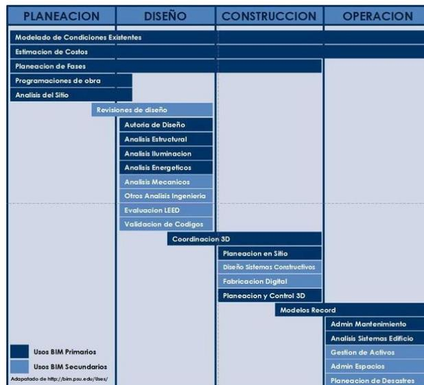
Figura 19. Usos BIM a través del ciclo de vida de una infraestructura. Obtenido de ("Identificando los Usos y Objetivos BIM para el proyecto | Construccion | Colombia | BIM Management," 2017)
