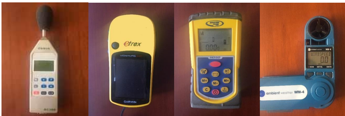
Figura 3.12. Equipo de medición: a. Sonómetro integrador analizador de espectro SC260, b. GPS eTrex Venture HC, c. Láser de precisión SPECTRA HD 50 y d. Anemómetro electrónico.
