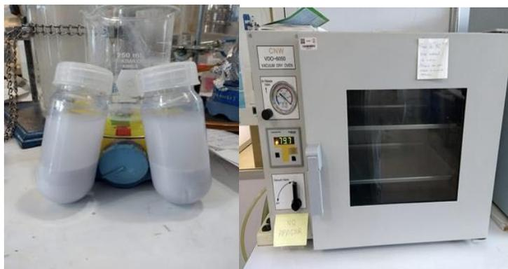
*Figura 2.2. Tubos de polipropileno con mezcla de reacción centrifugada y horno de secado al vacío.*
