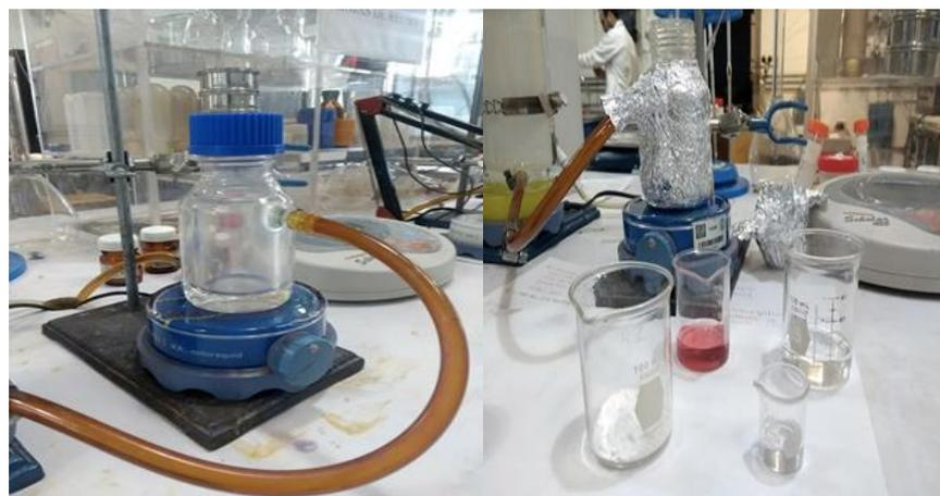
*Figura 2.1. Reactor batch de doble pared y compuestos utilizados en la síntesis DPU.*
