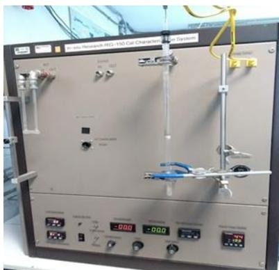
*Figura 2.3. Equipo In-situ Research RIG-150 Cat Characterization System.*
