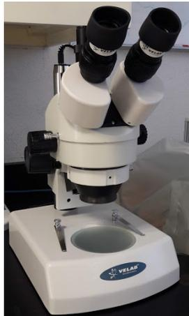
Figura 24.1. Estereomicroscopio modelo VE-S5 de la marca Velab.
