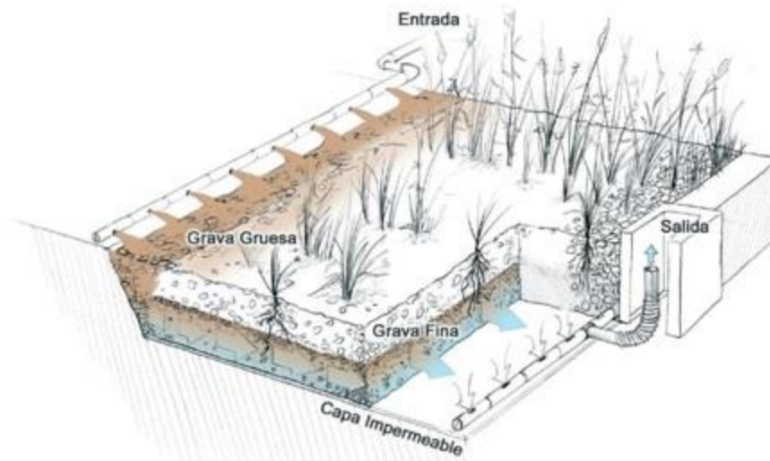
Fig. 3 Ejemplo del esquema general y funcionamiento de un Humedal artificial.
