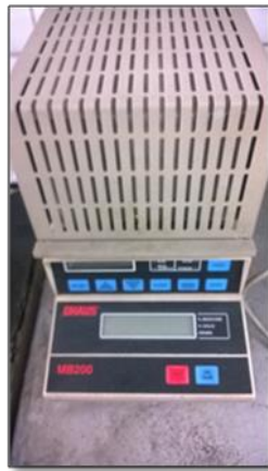
Figura A.1. Termobalanza
