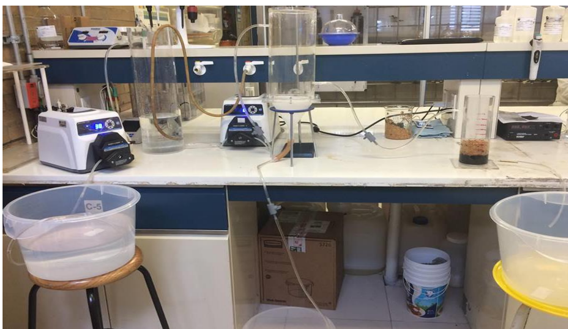
FIGURA 3. MONTAJE PARA EL PROCESO DE ABLANDAMIENTO QUÍMICO PARA AGUA CONGÉNITA.
