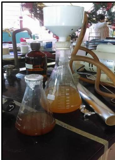
**Figura 16: Filtración al vacío con un embudo Büchner en un matraz kitasato.**
