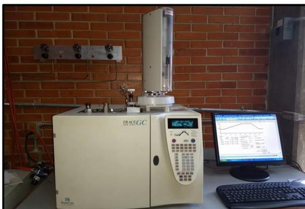
**Figura 9: Cromatógrafo de gases Trace GC 2000 series, empleado para la determinación del perfil de ácidos grasos.**
