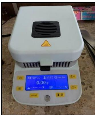
**Figura 17: Termobalanza BM utilizada para la determinación de humedad.**
