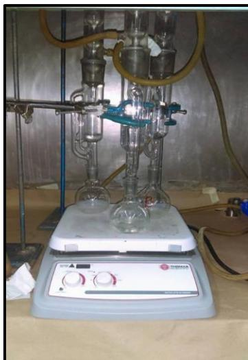
**Figura 15: Montaje de destilador Soxhlet, donde realiza la extracción de manera automática, con el mismo solvente que se evapora y condensa.**
