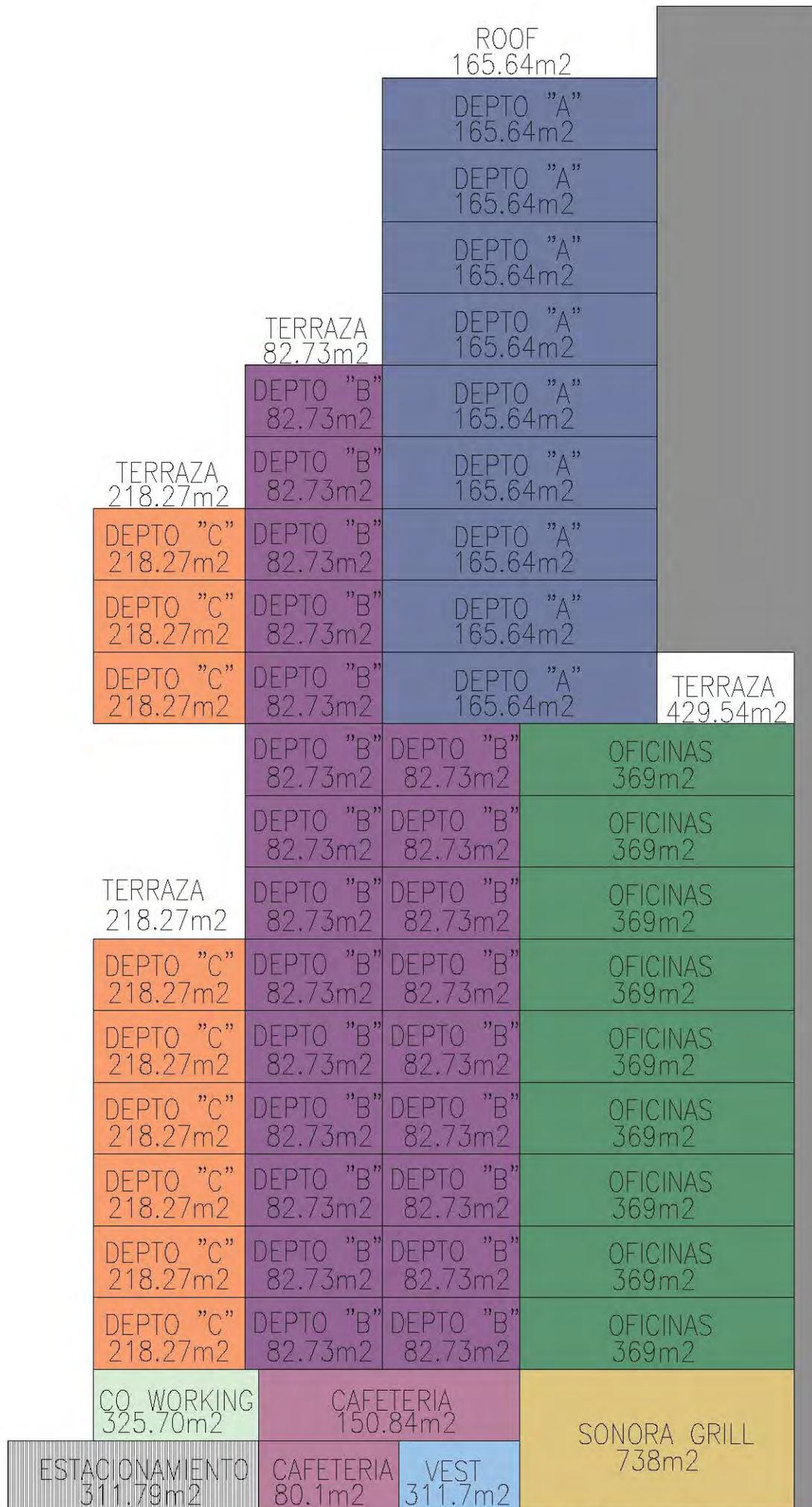
Imagen 47. Esquema de distribución de áreas en alzado
