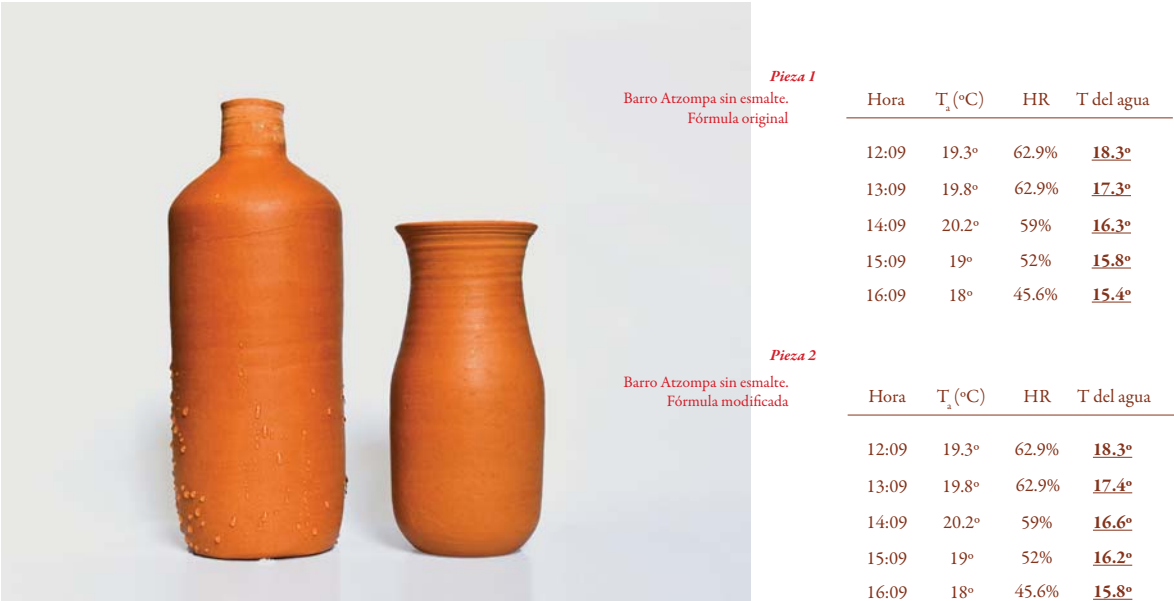
Figura 72. Prueba de rezumbe lateral. 13:08 hrs. Fuente: Propia
