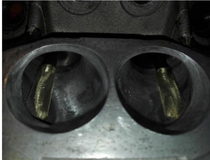
**Figura 3.4.** Puertos de admisión después del proceso de porteado y previo a pulido.
