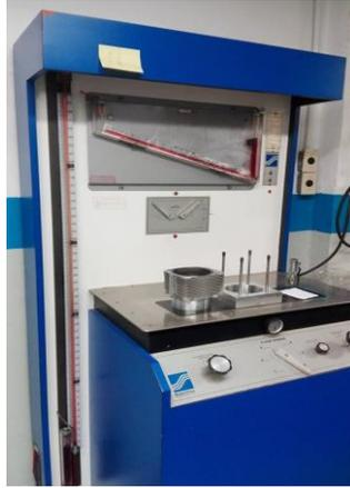
**Figura 3.6.** Banco de flujo empleado durante las pruebas. SF 750FC.
