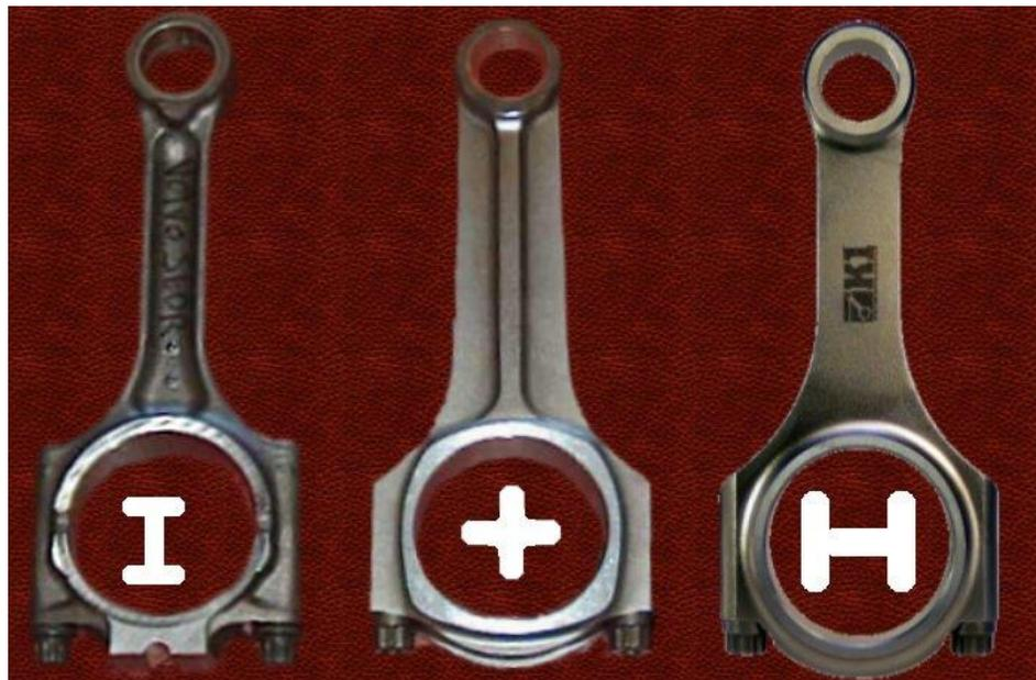
**Figura 1.8.** Diferentes perfiles de biela empleados, I, + y H.
