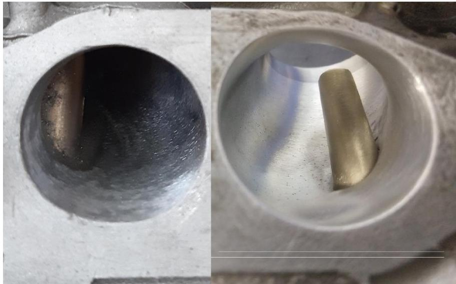
**Figura 3.5.** Puerto de admisión original (*izq.*), puerto de admisión modificado (*der.*). Se muestra el aumento de volumen del puerto (zona superior del puerto donde puede verse al exterior del mismo), la ampliación del radio corto (mayor curvatura) y el espacio extra de área al lado de la guía de válvula por la remoción de material.
