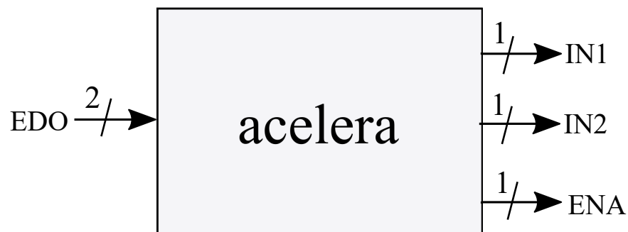
Figura 3.30: Entidad a diseñar para control del acelerador.
