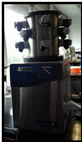
Figura 27 Liofilizadora (Fotografía de Oscar González Romero). (Laboratorio de Investigación y Posgrado en Tecnología Farmacéutica UNAM Campo 1, Cuautitlán Izcalli, Edo. de México, 2017). Archivo del autor
