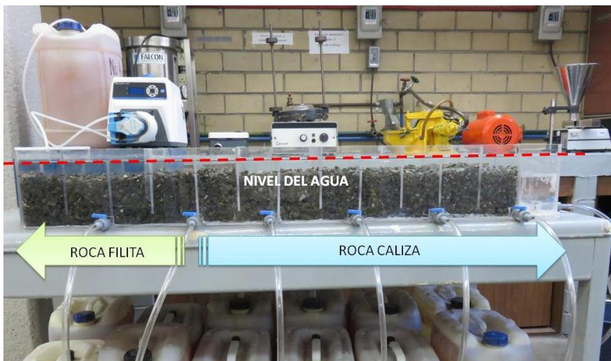
Figura 4-3. Preparación de la celda
