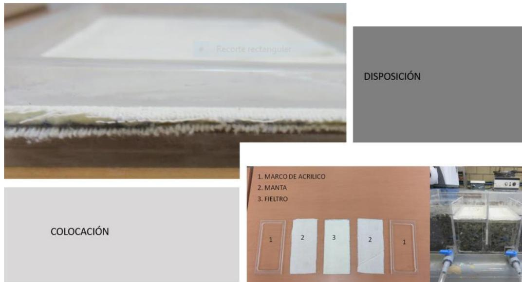
Figura 4-2. Disposición y colocación del filtro
