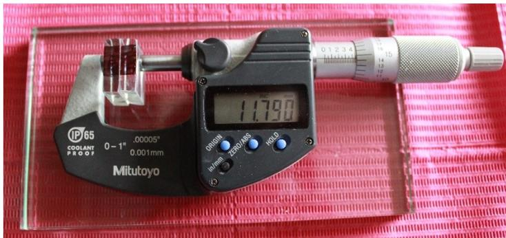
Figura 10. Medición de ambos vidrios.
