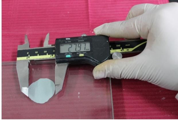
Figura 36. Medición de la muestra una vez concluido 60 segundos.
