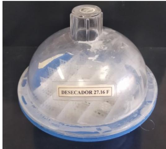
Figura 16. Desecador con las muestras en el interior.
