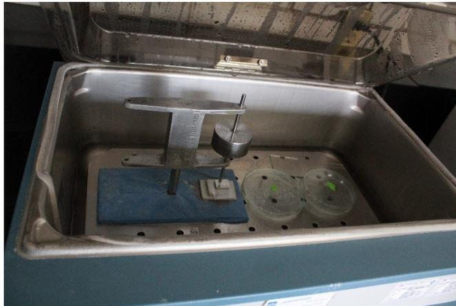
Figura 6. Molde con material dentro de la cámara de humedad y temperatura controlada.
