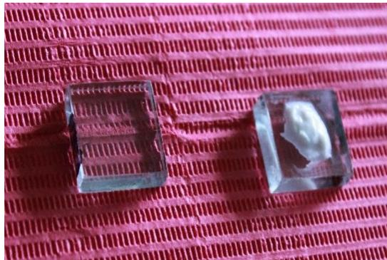
Figura 11. Material antes de colocar el vidrio superior.
