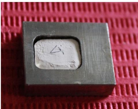
Figura 51. Muestra yeso/óxido de zinc/poliácido acrílico
