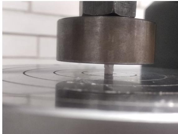
Figura 31. Muestra fracturada por acción de la fuerza aplicada por la máquina de pruebas mecánicas.
