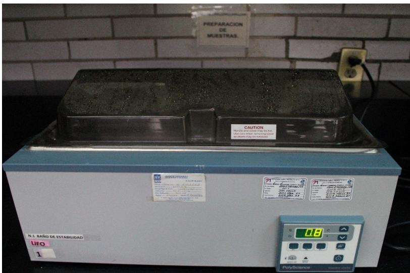
Figura 2. Cámara de temperatura y humedad controlada a  $37\pm 1^\circ\text{C}$  (PolyScience modelo WD20A1 1B, USA).
