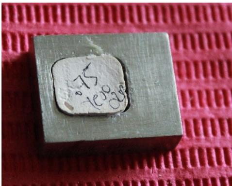
Figura 52. Muestra yeso/óxido de zinc/poliácido acrílico
