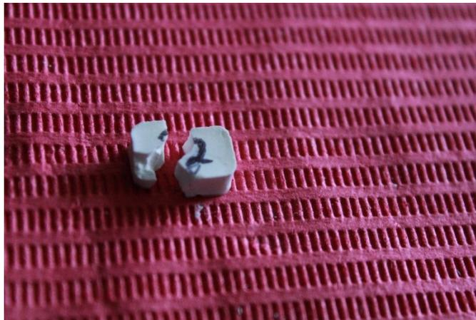
Figura 45. Muestra Ionómero de vidrio/poliácido acrílico fracturada después de 24h.
