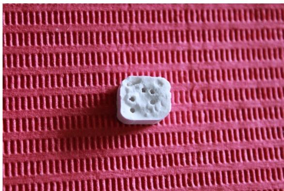
Figura 42. Muestra de relación 3:2 fraguada después de 24h.
