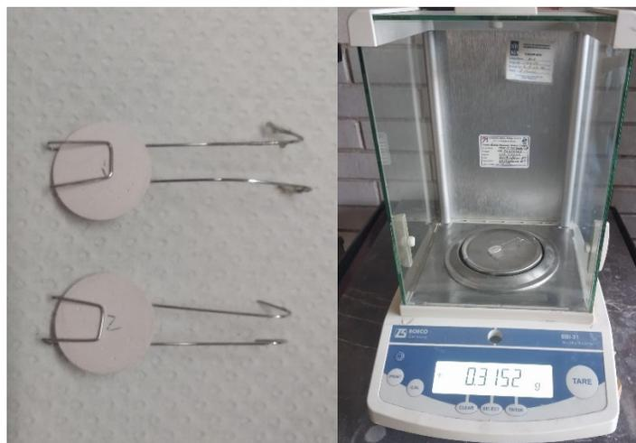
Figura 17. Muestras con el gancho para sujetar en los frascos y estén en contacto con el agua.
