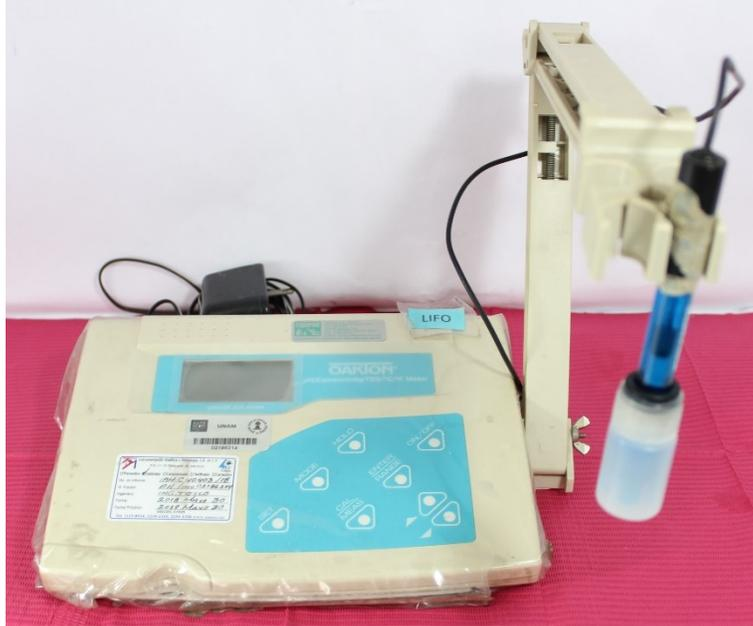
Figura 20. Potenciómetro (Oakton 500 .USA).
