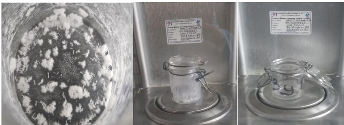
Figura 19. Pesado de los frascos vacíos y después de permanecer en el horno a 100°C.
