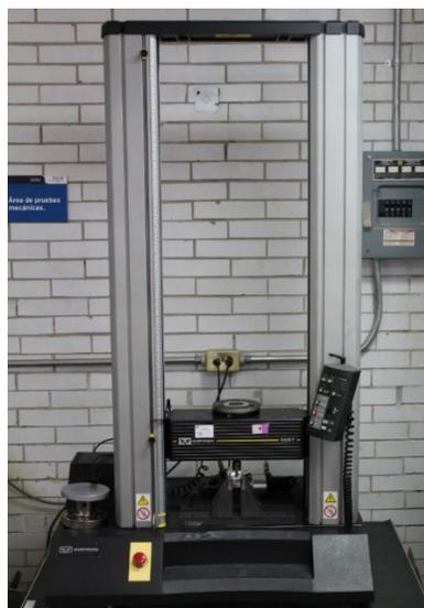
Figura 25. Máquina universal de pruebas mecánicas (Instron 5567, USA).
