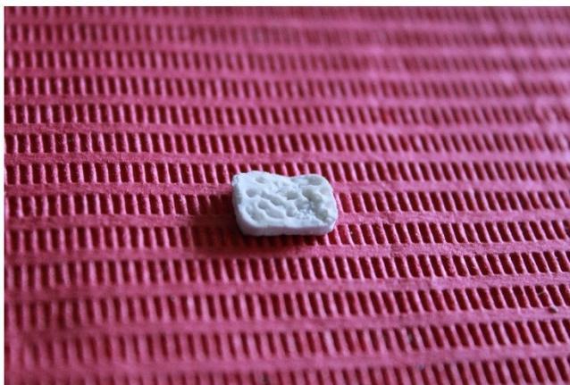
Figura 41. Muestra de la relación 3:2. Parte que consiguió fraguar después de 6 h.
