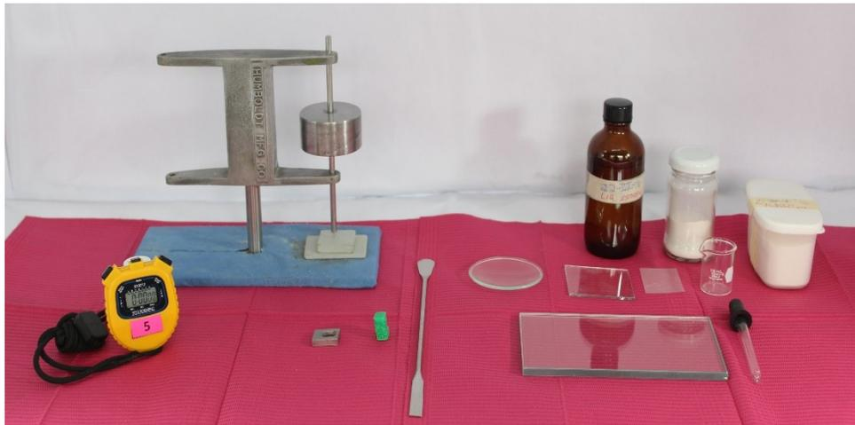
Figura 1. Materiales y equipo usados para prueba de tiempo de fraguado.
