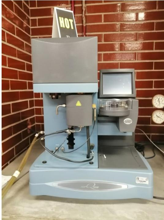
Figura 39. Equipo TA Instruments modelo TAGQ 5000 IR
