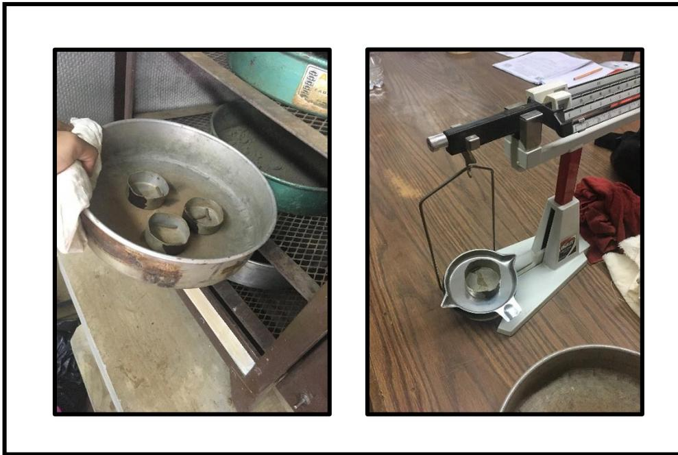
**Imagen 5.10.** Colocación de las muestras en el horno y pesaje.
