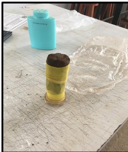
**Imagen 5.15.** Colocación de la membrana látex.
