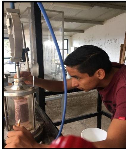
**Imagen 5.16.** Sellado de la cámara para aplicar aire y agua.
