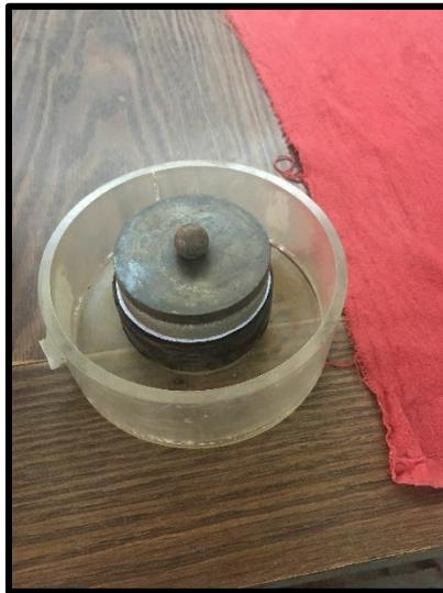
**Imagen 5.12.** Colocación de la muestra a ensayar dentro de la celda de consolidación.
