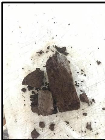
**Imagen 5.18.** Fractura del cilindro después de la compresión triaxial.
