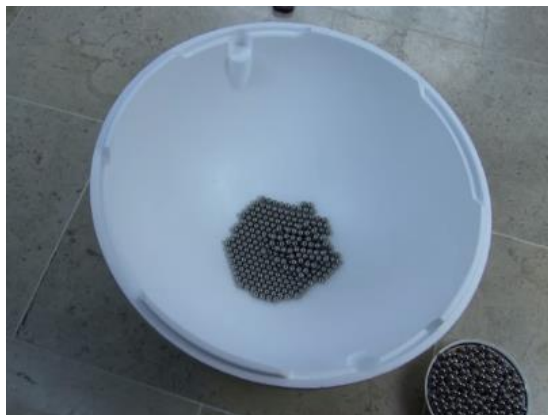
Figura 8-4 Solución con balines para la navegación del ballbot.
