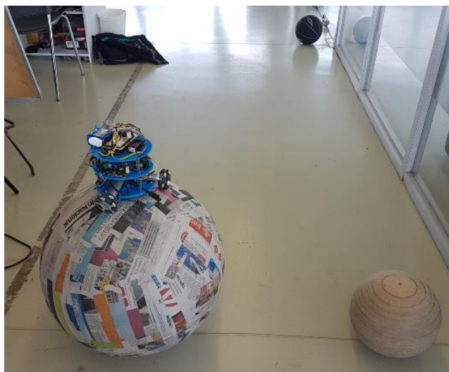
Figura 8-6 Preparación del robot para la primera movilidad con la nueva esfera.
