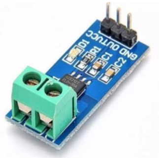
Figura 5-12 Sensor de corriente ACS712.
