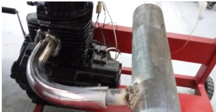
Figura 44. Acoplamiento del tubo de dilución al escape del motor.
