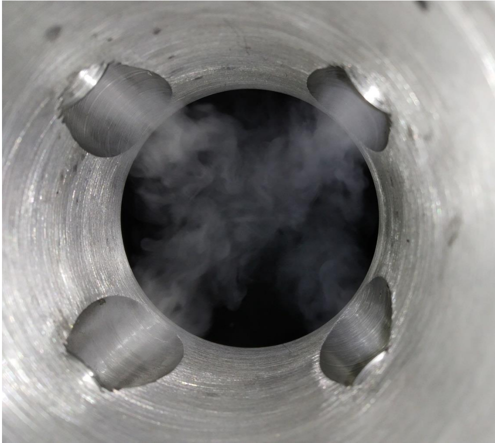
Figura anexo 2. Vista superior donde 4 transductores se encuentran funcionando en la pieza 3.
