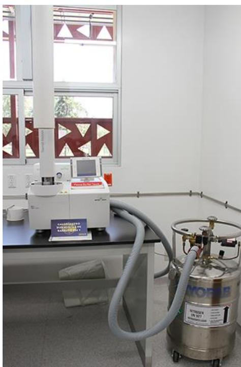
Fig 11. Equipo utilizado para la prueba DSC.
