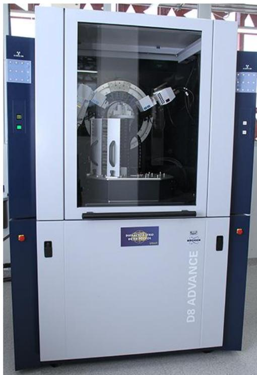
Fig 12. Equipo utilizado en la prueba de difracción de rayos X de polvos.
