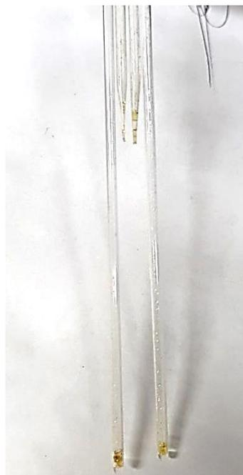
Fig 17. Capilares utilizados en la prueba de punto de fusión.
