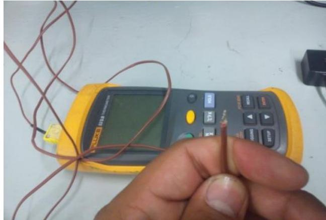
Figura 8. Termómetro digital FLUKE® 53-II B equipado con un termopar tipo K.
