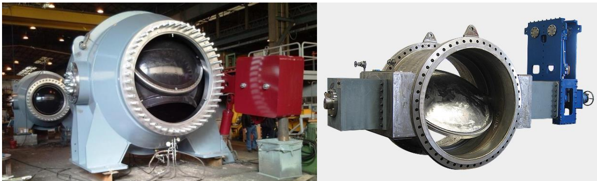
Figura 23. Válvula de bola (izquierda) y de mariposa (derecha) (Válvula de Bola) (Válvula de Mariposa)
