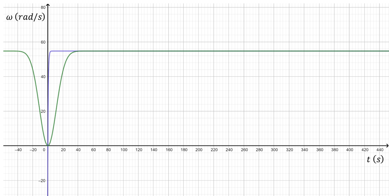
Figura 27. Gráfica que muestra la solución de las velocidades angulares para cada uno de los pares. La curva azul presenta la solución para un par constante, y la curva verde presenta la solución para un par dependiente del tiempo.
