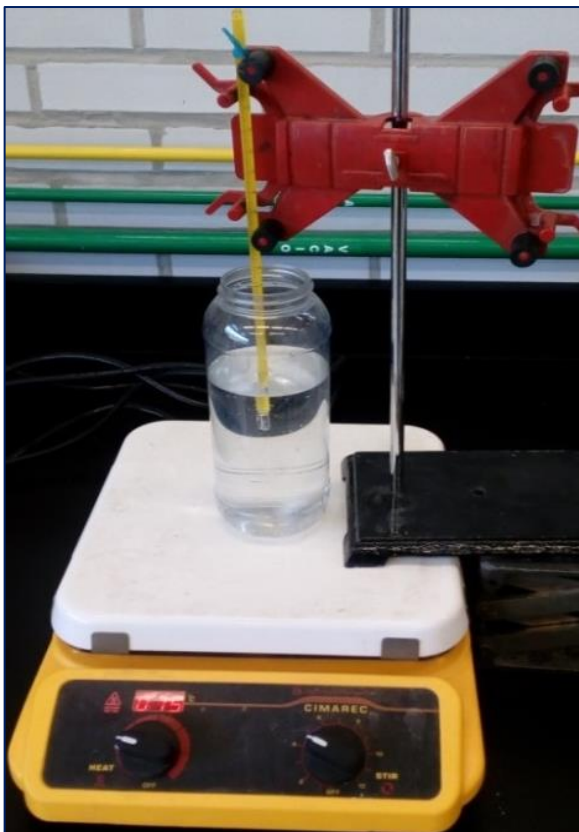
Fotografía 23.- Armado del sistema para la preparación del S.B.F.
