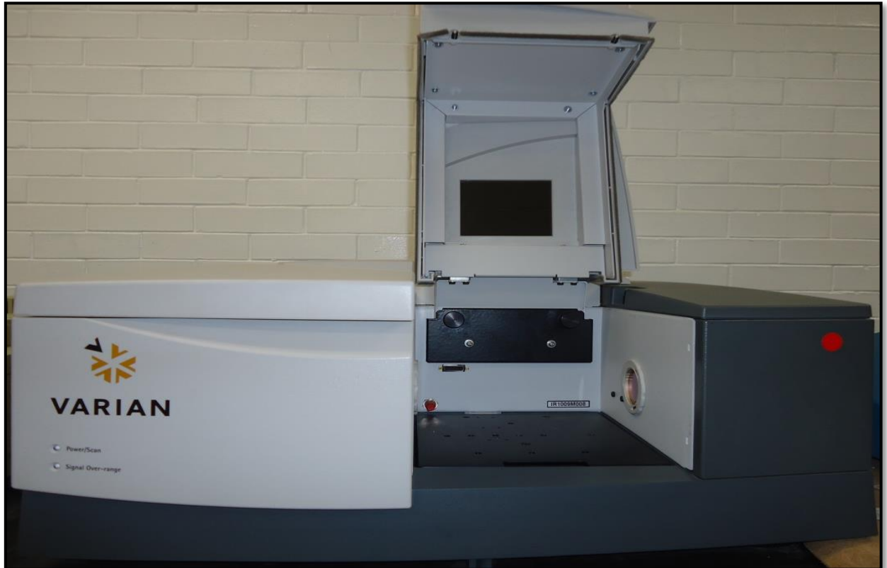
Fotografía 37.- Equipo de FT-IR.
