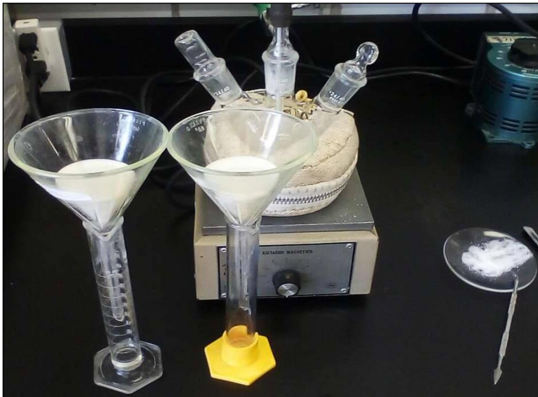
Fotografía 4.- Filtrado de la solución y obtención de Sol A2.
