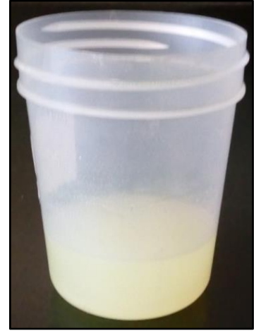
Fotografía 8.- Adición del Sol de silicio (Sol A2) a la solución c.
