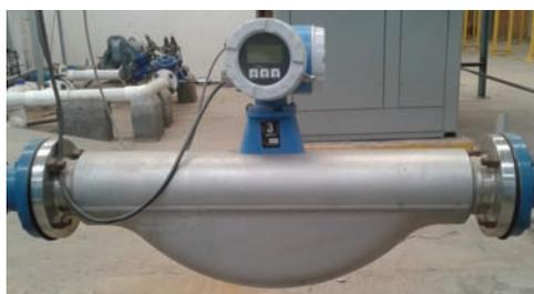
**Fig. 2.10** Sensor de flujo Protomass 83F colocado en el ducto piloto de cuatro pulgadas.
