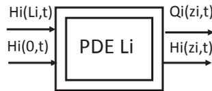
**Fig. 2.6** Cuadripolo asociado a las PDE 2.15 y 2.16 de la sección  $i$  de longitud  $L_i$  con condiciones de frontera  $H_i(0, t)$  y  $H_i(L_i, t)$
