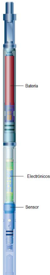
Fig. IV.2.4.4 Esquema de la sonda Signature CQG , ( Schlumberger ).
