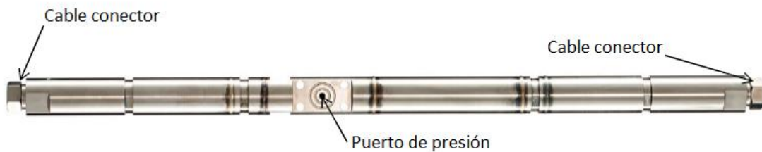
Fig. IV.2.6.1.1 Esquema de la Sonda SmartPort FBG, ( Smart Fibres ).
