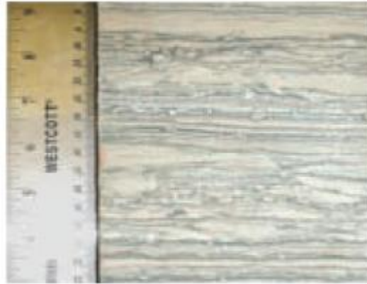
Figura 1.10 Las laminaciones en este ejemplo de núcleo tienen aproximadamente un milímetro de grosor, típico de las secuencias de turbiditas encontradas en cuencas de aguas profundas. La resolución vertical mínima para herramientas de inducción es de 3 [cm] (Tomado de Schlumberger, 2009).
