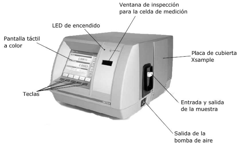
Figura 4.3 Componentes principales del densímetro de tubo vibrante de baja presión.
