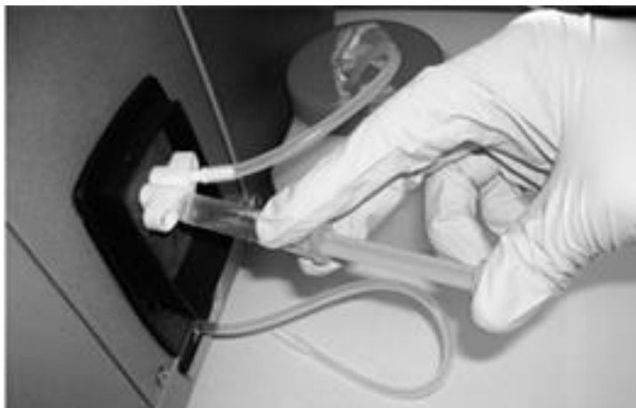
Figura 4.4. Proceso de llenado de muestra en la celda del densímetro de tubo vibrante.
