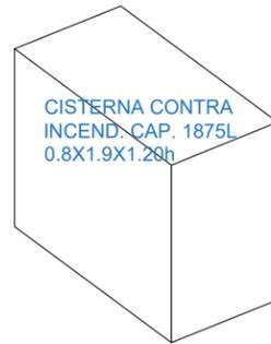
Independiente a ello se consideró una dotación de agua contra incendios de 1/3 de la dotación mínima de consumo diario de 1875L en una cisterna de 1.875 m<sup>3</sup>. La tubería utilizada es de tubo de cobre con diámetros nominales de 38mm a 1" como máximo en los ramales principales.
