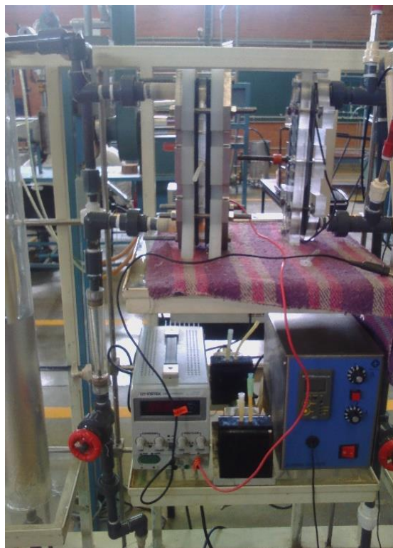
Figura 21. Montaje experimental para la degradación del Colorante reactivo naranja 16.
