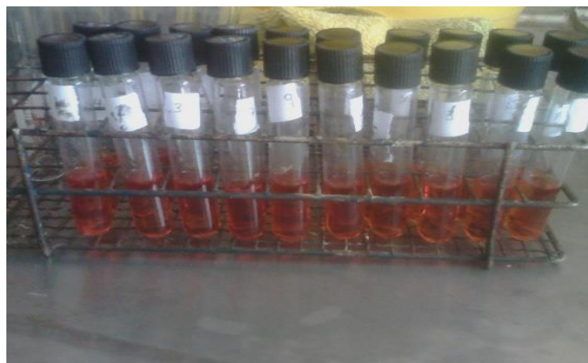
Figura 14. Muestras del colorante reactivo naranja 16 que se llevaron a digestión durante dos horas.
