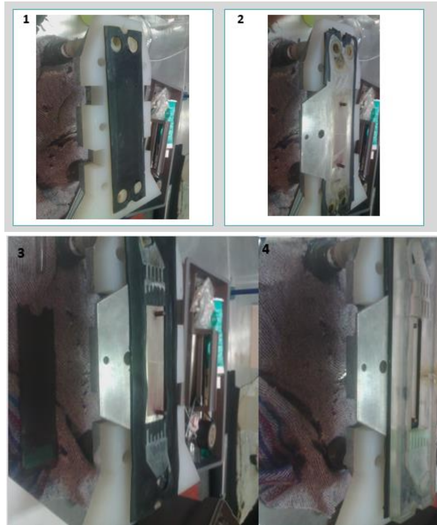
Figura 18. Orden de las placas que forman el reactor filtro prensa FM01-LC del 1 al 4, (1) muestra las placas traseras del reactor con un empaque de neopreno, (2) el electrodo de acero inoxidable, (3) se adiciona otro empaque de neopreno, (4) y posteriormente el distribuidor de líquidos.
