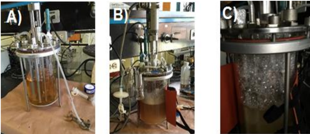
Figura 3.44 Producción de biosurfactante por la cepa IMP-G en un bioreactor de tipo tanque agitado A) T=0 h, B) T=24 h y C) T=48 h.
