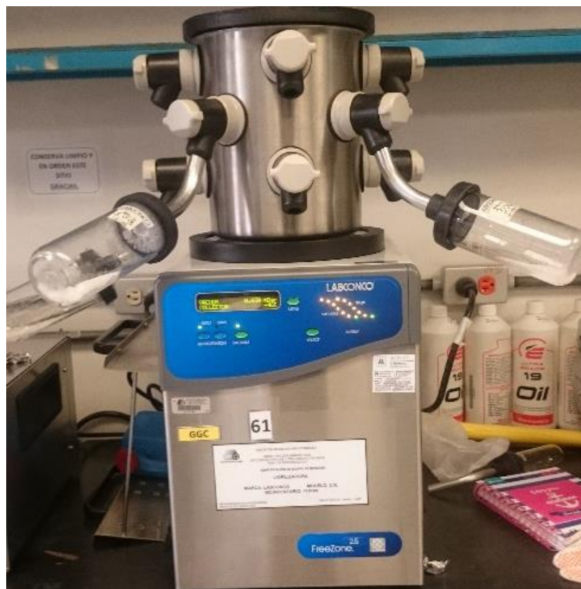
Figura 2.2 Liofilizadora marca Labconco freezone 2.5 L.
