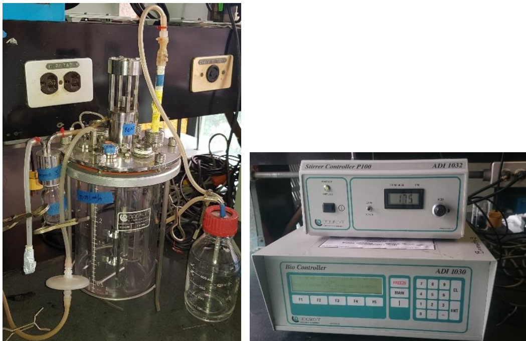
Figura 2.1 Tanque de bioreactor, controlador y agitador Applikon.
