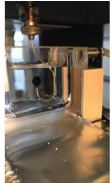
Figura 3.41 Forma de la gota pendiente sistema [A] aceite 600F/biosurfactante 30°C; [B] aceite 600F/agua destilada 30°C sin sal.
