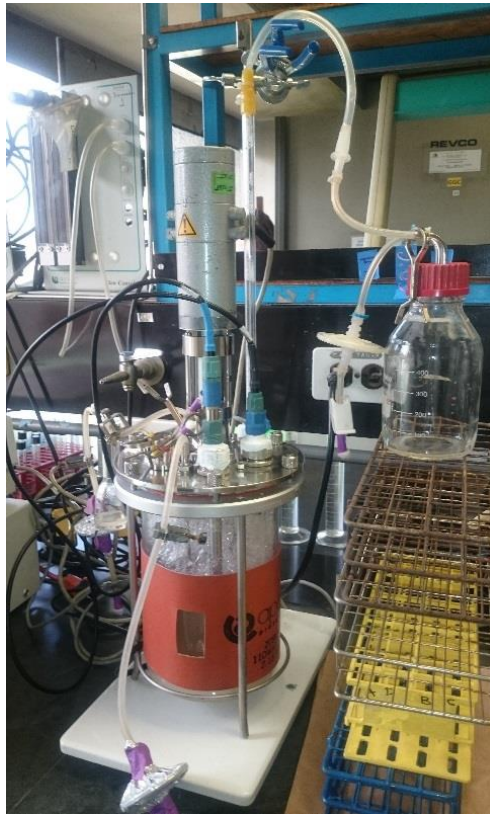
Figura 3.45 Bioreactor con apertura superior y conexión de manguera a un frasco para la recolección de espuma.
