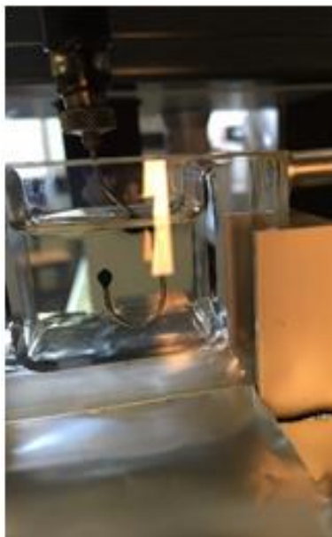
Figura 3.41 Forma de la gota pendiente sistema [A] aceite 600F/biosurfactante 30°C; [B] aceite 600F/agua destilada 30°C sin sal.
