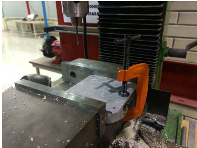
Figura 3.23: Perforación de los agujeros para acoplar la carcasa inferior con la base de montaje.
