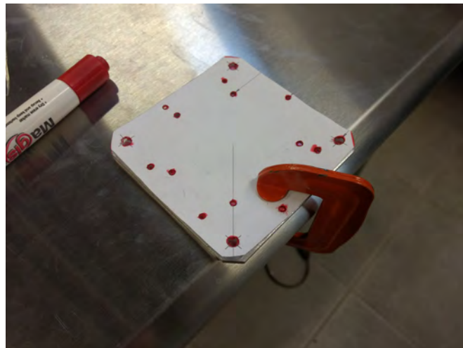
Figura 3.22: Marcado con plumón de cada uno de los agujeros a perforar en la base de montaje.
