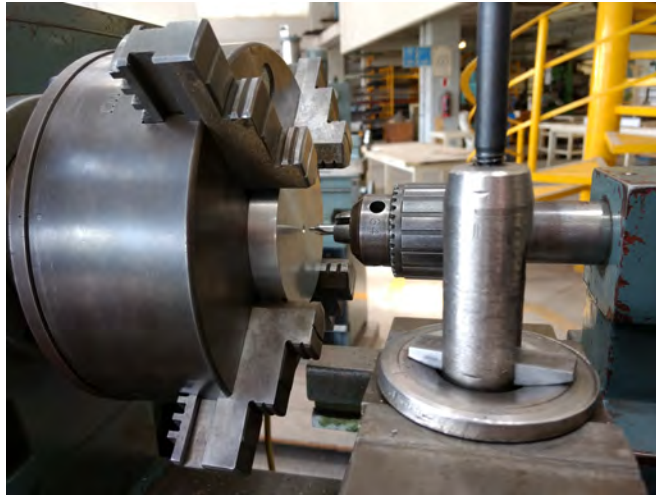
Figura 3.19: Marcado del centro del volante de inercia.
