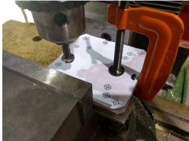
Figura 3.24: Proceso de avellanado de la base de montaje.
