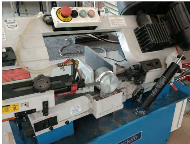
Figura 3.18: Sierra automática de cinta cortando la barra de aluminio.
