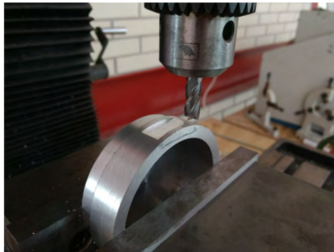
Figura 3.20: Proceso de manufactura de la cavidad para el conector DB9 en la carcasa inferior.
