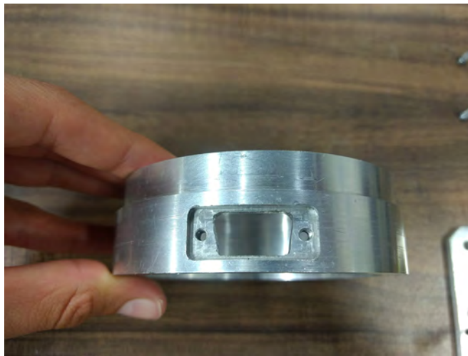
Figura 3.21: Proceso de manufactura de las cavidades para el conector DB9 de la carcasa inferior.
