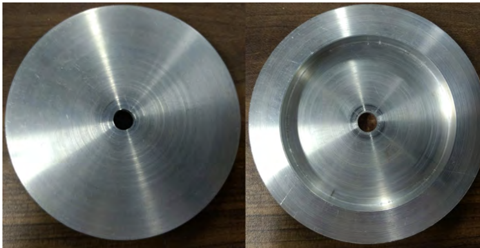
Figura 4.5: Prototipo de volante de inercia. a) Vista superior b) Vista inferior
