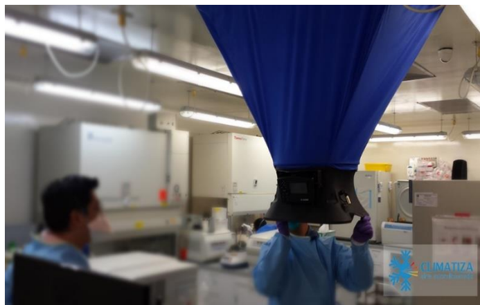
Figura 8. Muestra la utilización de un balómetro para medir el caudal de aire suministrado en cada filtro.
