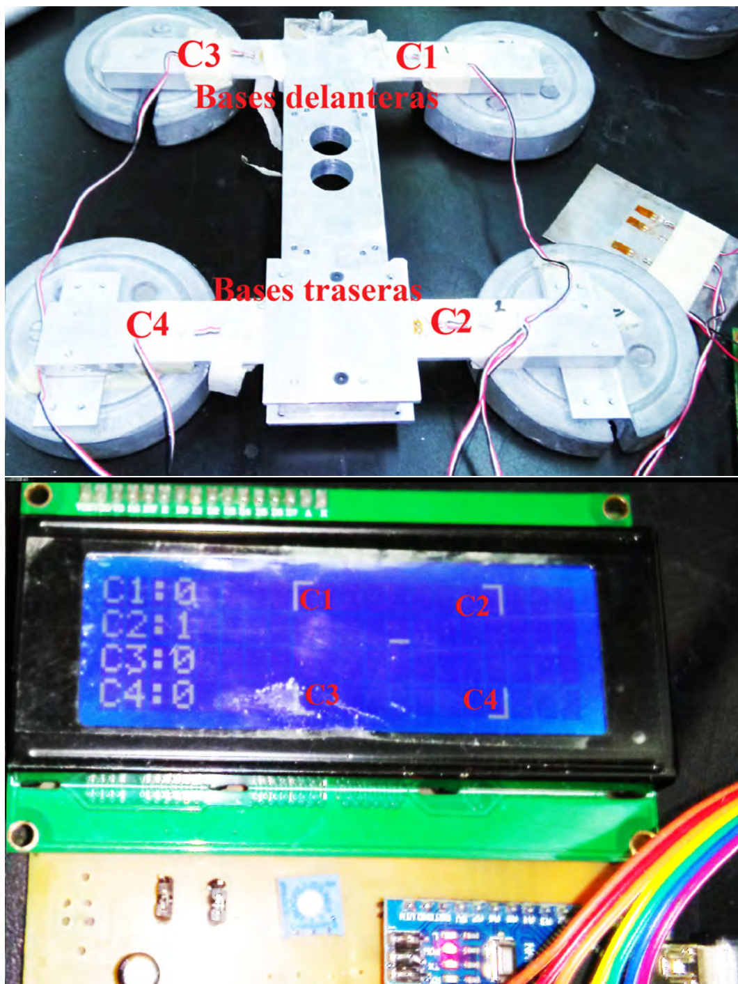
Figura 3.23. En la parte superior, la plataforma de las pruebas conectada a la tarjeta de adquisición, se señala con la inicial C el canal por el cual es monitoreada la galga de esa base, en la parte inferior, el display en la tarjeta de control, al no haber carga sobre la plataforma no existe deformación.
