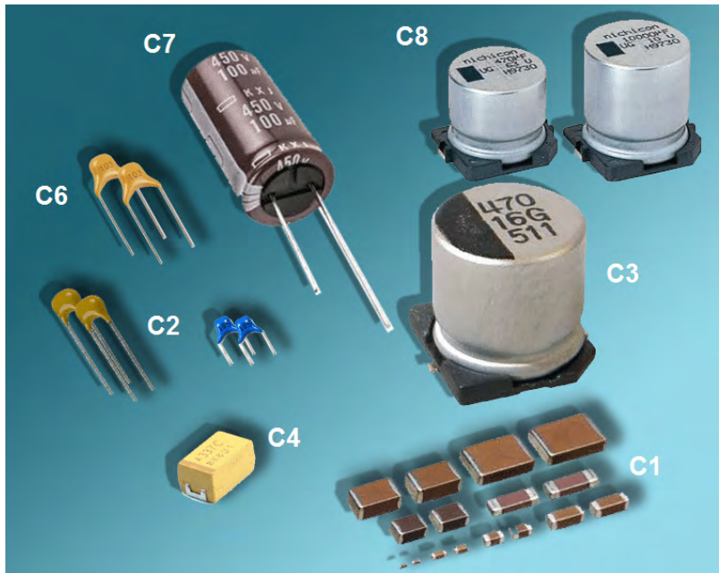
Figura 3.10. Encapsulados para capacitores, la numeración corresponde a las huellas de la Figura 3.9. [30]
