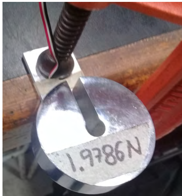
Figura 3.7. Fotografía de una de las pesas utilizadas sobre la probeta.
