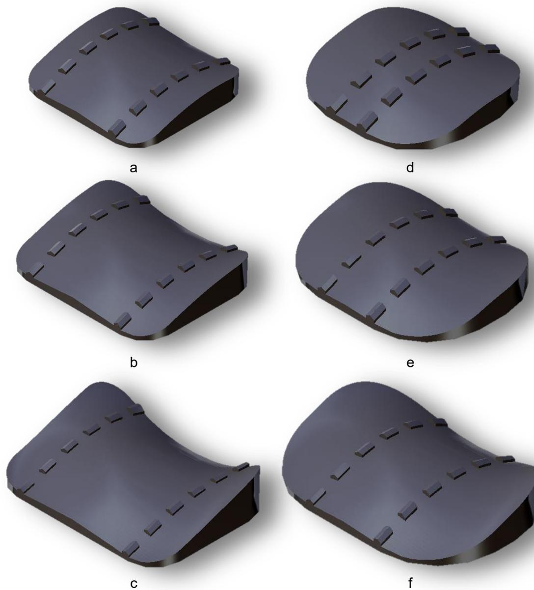
Figura 64. CAD de la placa craneal de la prótesis de disco intervertebral C5/6 y C6/7: a) chica, b) mediana, y c) grande. CAD de la placa caudal de la prótesis de disco intervertebral C5/6 y C6/7: d) chica, e) mediana, y f) grande.
