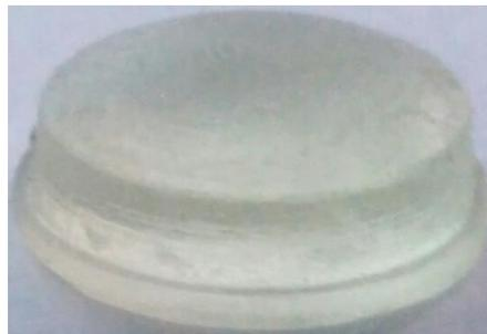
Figura 77. Prototipo del núcleo de la prótesis de disco intervertebral cervical.
