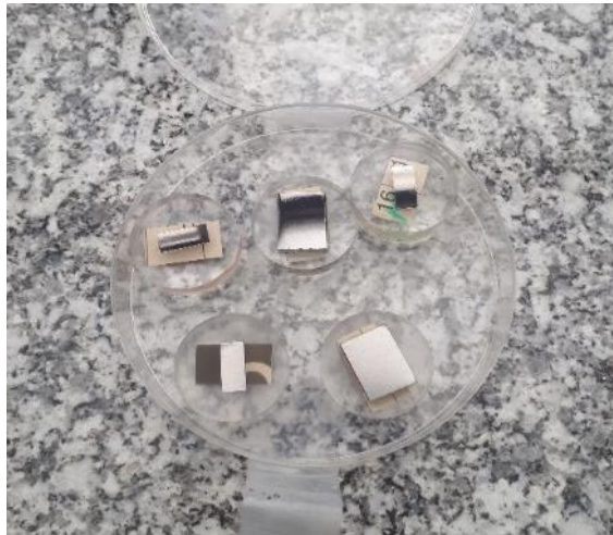
Figura 5: Muestras encapsuladas en resina transparente.
