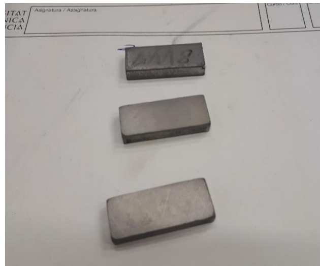
Figura 28: Probetas obtenidas después de compactación.
