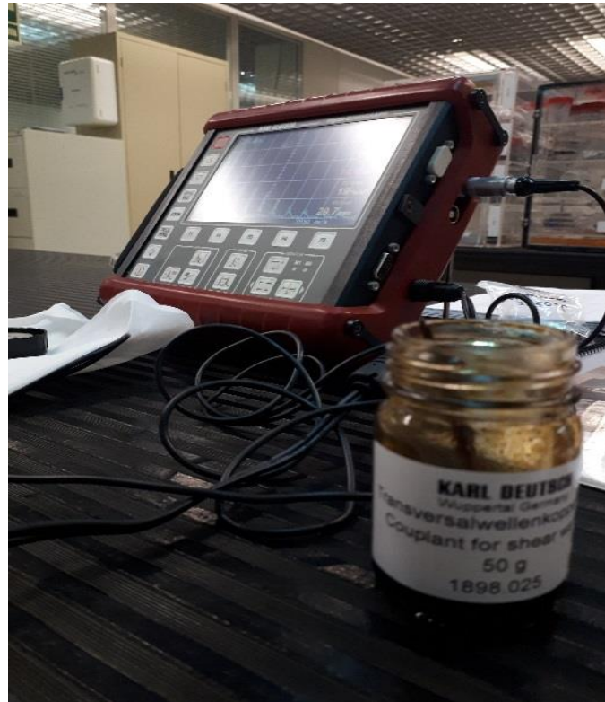
Figura 30: Ecógrafo y melasa para prueba de ultrasonido.
