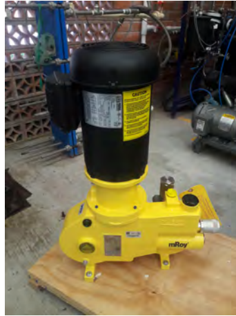
Figura 3.7: Bomba de pistón
