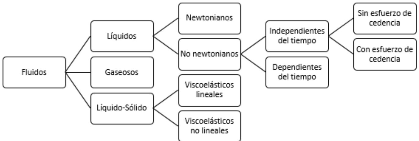
Figura 2.1.1. Clasificación de los diferentes tipos de fluidos según su naturaleza reológica.
