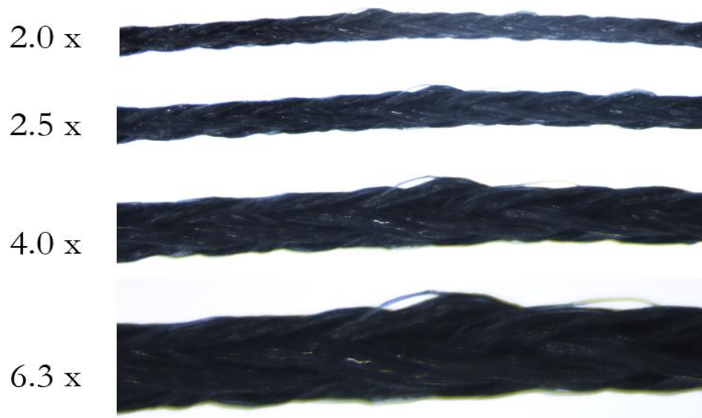
Figura 13. Suturas de seda vista con estereoscopio a diferentes ampliaciones. Fuente: directa
