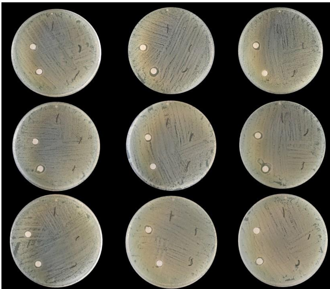
Figura 23. Ensayos de actividad antimicrobiana con el método de difusión de agar en contacto con la cepa E. coli . Fuente: directa.
