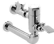
Fluxómetro para mingitorio de pedal expuesto marca HELVEX. Entrada superior para spud de 19 mm. y alimentación de 1", desaloja 1/2 litro por descarga. Presión mínima requerida 1 kgf/cm2.
